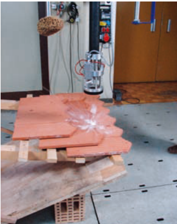
Abbildung 6.19: Hagelkanone mit aufgebauten Ziegeln, Foto Empa.
